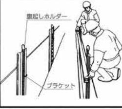
**2** 腹起しの間隔より少し短めにスーパーSSジャッキの寸法を合わせる。
