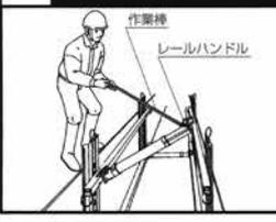
**4** 作業棒の先端のソケットをジャッキのスナパノ口に差し込み、ラチェットレンチをセットし、仮締めする。
